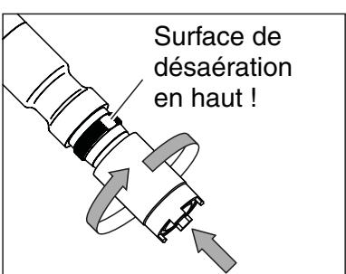
Tenir la sonde inclinée et visser à main la tête à membrane en la tenant avec un essuie-tout en papier. Le trop-plein de solution d'électrolyte sort par la surface de désaération.
