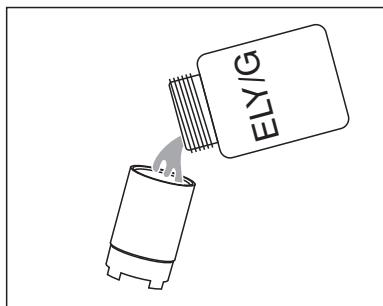
Remplir une tête à membrane neuve avec de la solution d'électrolyte ELY/G.
