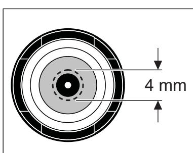
Contrôler le remplissage: examiner la surface frontale. Aucune bulle d'air ne doit être visible à l'intérieur du cercle marqué par des tirets. Les bulles d'air se trouvant à l'extérieur de cette zone sont sans importance.
