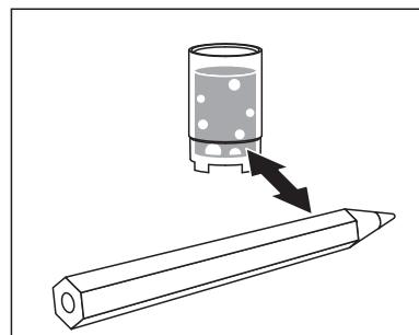
Eliminer les bulles d'air éventuelles par de légers frappements. Il est également possible d'empêcher la formation de bulles d'air en jetant le premier remplissage et en remplissant à nouveau.
