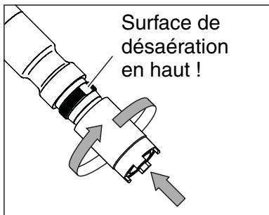
Tenir la sonde inclinée et visser à main la tête à membrane en la tenant avec un essuie-tout en papier. Le trop-plein de solution d'électrolyte sort par la surface de désaération.
