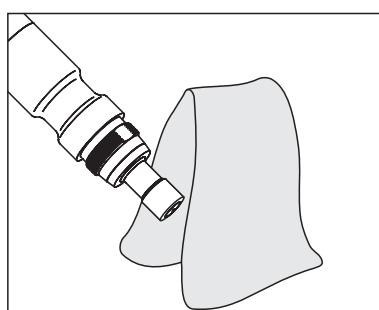
Essuyer la contre-électrode avec un essuie-tout en papier ne peluchant pas et la débarrasser avec précaution du dépôt blanc détaché.
