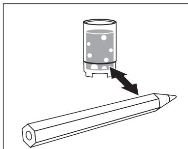
Eliminer les bulles d'air éventuelles par de légers frappements. Il est également possible d'empêcher la formation de bulles d'air en jetant le premier remplissage et en remplissant à nouveau.
