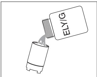
Remplir une tête à membrane neuve avec de la solution d'électrolyte ELY/G.
